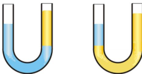
un tubo en U funciona igual aunque esté inclinado, o sus ramas tengan diferente largo o grosor
