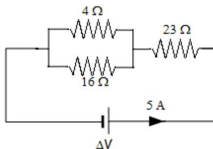
10. Dado el circuito de la figura, calcular el valor de la intensidad de corriente ( $i$ )
