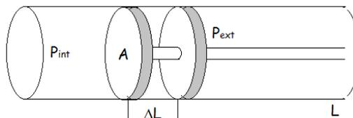
**Trabajo de expansión.** Cuando el gas se expande y mueve el pistón de área  $A$  por una distancia  $\Delta L$ , se realiza el trabajo  $\Delta L \times F$ , donde  $F = A \times P_{ext}$  (recordar que  $P = F/A$ , siendo  $F =$  fuerza)
