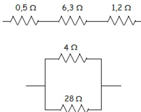
7. Aplicando la Ley de Ohm, determinar la intensidad de corriente ( $i$ ) que circula por el circuito siguiente
