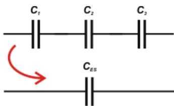
Dos o más capacitores están conectados en serie cuando están conectados entre sí por sus placas de polaridad opuesta. El grupo puede reemplazarse por un único capacitor, capaz de acumular la misma carga que el conjunto, y que por ello recibe el nombre de capacitor equivalente en serie,  $C_{ES}$ .
