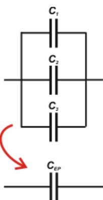
acumular la misma carga que el conjunto, y que por ello recibe el nombre de capacitor equivalente del paralelo,  $C_{EP}$ . El valor del capacitor equivalente se obtiene mediante:
