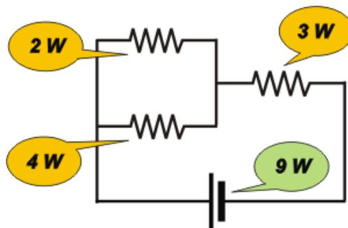
Las fuentes, pilas o baterías entregan energía, el resto de los elementos, disipan toda la energía en su totalidad (aunque parte de la energía se "pierda" como calor).
