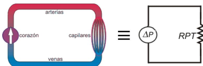
Esa diferencia de presión es igual a la que disipa el circuito debido a su resistencia hidrodinámica, acá representada como una única resistencia que recibe el nombre de resistencia periférica total (RPT).
