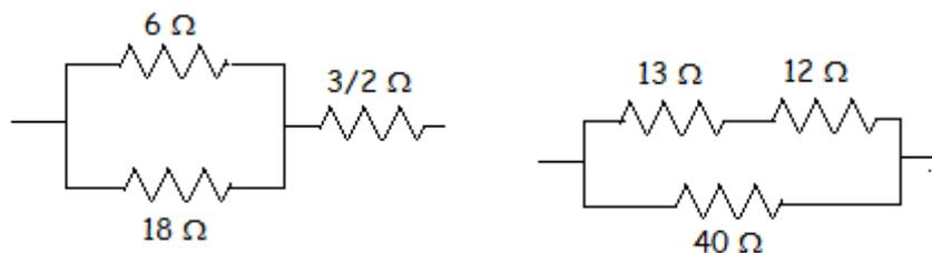
9. Dado el circuito de la figura, calcular el valor del voltaje aplicado ( $\Delta V$ )
