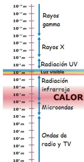
El calor puede viajar en forma de radiación. La radiación que transporta el calor no necesita de materia para desplazarse dado que lo hace como **radiación electromagnética**. El gráfico de la izquierda representa el espectro continuo de la radiación electromagnética desde los rayos más energéticos y penetrantes (arriba) hasta los más blandos e inofensivos (abajo). La columna de la izquierda representa la longitud de la onda.
