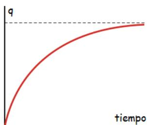
Los capacitores almacenan energía eléctrica que después se puede aprovechar para otros fines como por ejemplo el encendido de un aire acondicionado, un tubo de luz fluorescente, o el potencial de acción de una célula nerviosa. En el gráfico se muestra la carga de un capacitor, desde que empieza a cargarse hasta que adquiere la carga completa (*Importante! Una vez cargado el capacitor, no hay más movimiento de cargas por esa rama del circuito, o sea, la corriente eléctrica será cero*).
